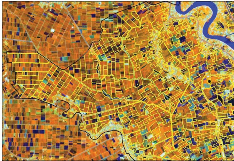
ภาพ การผสมสีเท็จ (FALSE COLOR COMPOSITE: FCC) R-G-B แบนด์ 4-5-3 ด้วยดาวเทียม SENTINEL-2 ที่เป็นระบบ OPTICAL SENSOR บริเวณ อำเภออินทร์บุรี จังหวัดสิงห์บุรี ซ้อนทับกับผลการแปลเนื้อที่เพาะปลูกข้าว ณ วันที่ 4 มิถุนายน 2568
