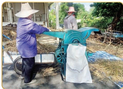
การนวดข้าวโดยการใช้ตู้นวดข้าว เครื่องยนต์ดีเซล
